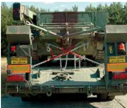
Odciągi łańcuchowe ZRS 13 G8 mocujące pojazd WZT na naczepie niskopodwozowej NS600W produkcji AUTO-HIT
