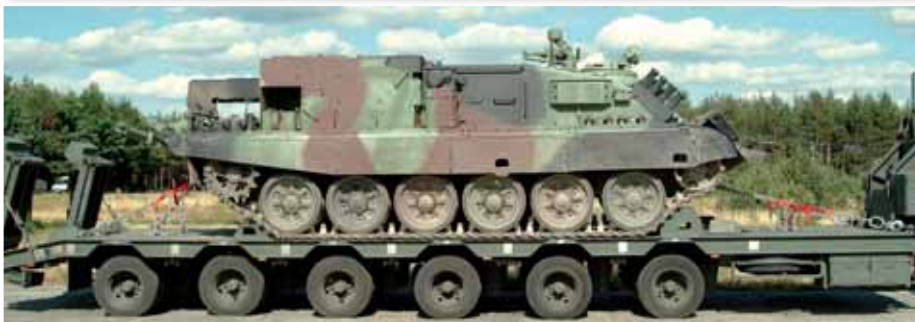
Odciągi łańcuchowe ZRS 13 G8 mocujące pojazd WZT na naczepie niskopodwozowej NS600W produkcji AUTO-HIT
